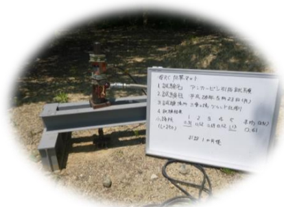
ピンの引抜き強度試験
