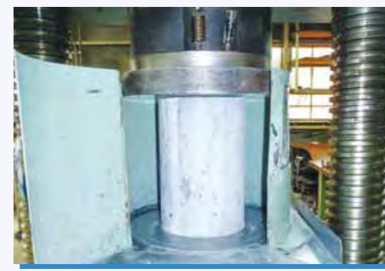
コンクリート圧縮強度試験
