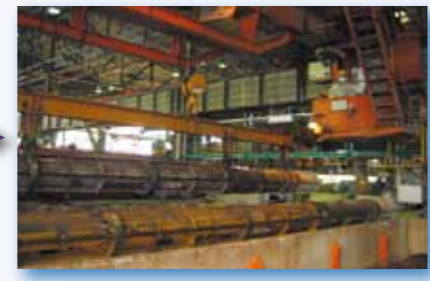
9. 蒸気養生 遠心成形された型枠を養生室に入れ、自動温度調節器により温度管理を行い、蒸気養生します。
