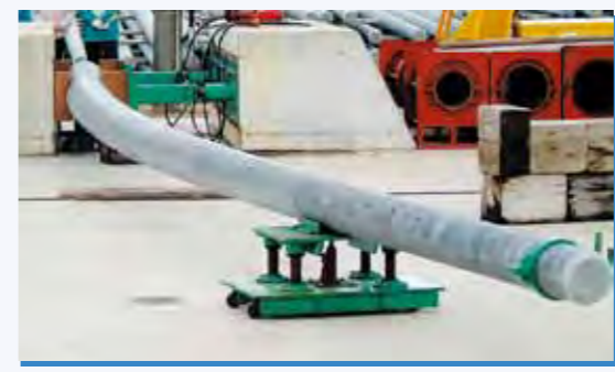
コンクリートポールの曲げ耐力試験
