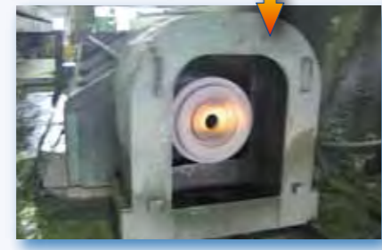
8. 遠心成形 自動制御装置により回転速度 (初速・中速1・中速2・高速の4段階) 及び回転時間を管理し、締め固めます。
