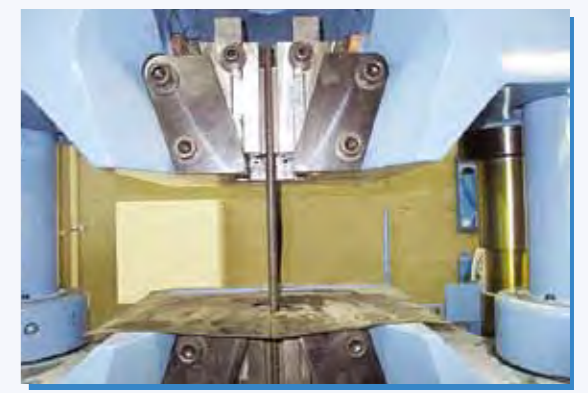
鉄筋引張試験
