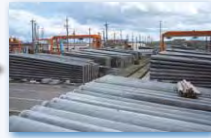
11. 気中養生 (野積養生) 蒸気養生後の製品は、屋外の製品置場でさらに所定の強度に到達するまで養生をおこないます。
