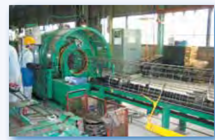
2. 鉄筋かご組立 主鉄筋にらせん筋を巻き付けたかごの中にPC鋼線を通し、更に両端の端板に通してから定着用のヘッティング加工を施し、正確に組み立てます。
